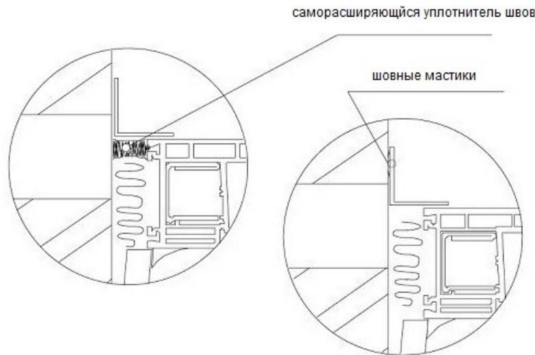
Рисунок 9. Дополнительное уплотнение наружного шва.
